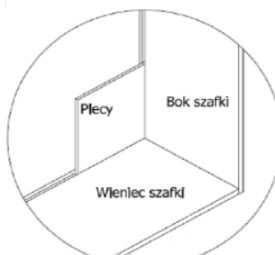
Schemat konstrukcji komody - plecy
