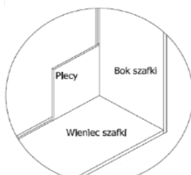
Schemat konstrukcji komody - plecy
